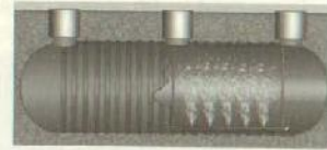
Figura 4. Tanque de aireación usado en el tratamiento secundario
