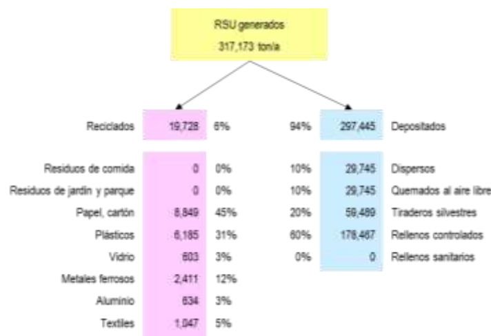
Figura 44. Reciclaje y disposición de residuos que se generan en el municipio, (resultados de la herramienta MRS-GEI).
